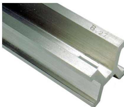
Obr. 2.2 Po podpísaní Metrickej konvencie v roku 1875 vyrobil BIPM zo zliatiny platiny a irídia 30 prototypových etalónov metra. Fotografia zachycuje Národný prototyp metra č. 27, ktorý v roku 1890 získali Spojené štáty americké.
